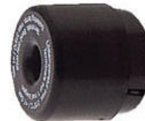
Cette génératrice à faible inertie avec commutation en métaux précieux est l'accessoire indispensable pour l'affichage ou la recopie de la vitesse dans une boucle d'asservissement. A préférer à l'utilisation d'un codeur dans des applications motorisées à basse vitesse, cette génératrice ne peut être associée aux moteurs RE026CLL, RE026G et RE035G que lors de la fabrication.
