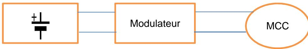
La batterie d'accumulateurs fournit l'énergie électrique au moteur qui propulse le vélo, En fonctionnement nominal, le moteur absorbe une intensité de courant de 12A
