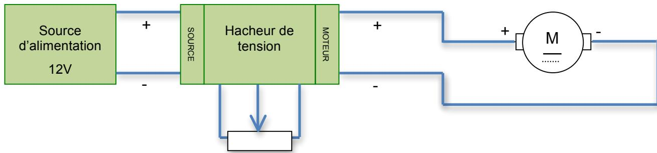
Le hacheur de tension permettra d'obtenir différents niveaux de tension, de zéro volts jusqu'à la tension nominale. Il se règle à l'aide d'un potentiomètre et se connecte à l'aide d'un bornier à 4 bornes :
